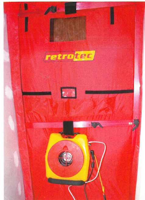
La porte soufflante est fixée sur l'entrée de la maison. Au centre, le ventilateur permet de mettre la maison en dépression.
