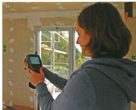
La température intérieure est trop proche de la température extérieure pour utiliser la caméra thermique.
